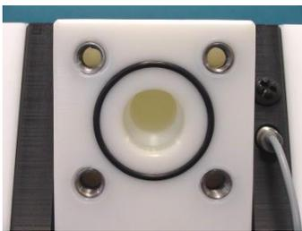
Diese Ausführung ermöglicht Flanschanschlüsse nach DIN/PN10 oder ANSI. Die Gewindebuchsen aus Edelstahl (Code F3/F4/F5/F6 bzw. F3w/F4w/F5w/F6w bei ANSI) für die Flanschbefestigung befinden sich im Zentralgehäuse. Vor dem Pumpenanschluss müssen zur Abdichtung die beiliegenden Flansch-O-Ringe in die Nut um die Produktanschlüsse eingelegt werden. Die Flansch-O-Ringe bestehen aus EPDM (Code F 3), FEP (Code F 4), NBR (Code F 5) oder FKM (Code F 6)
