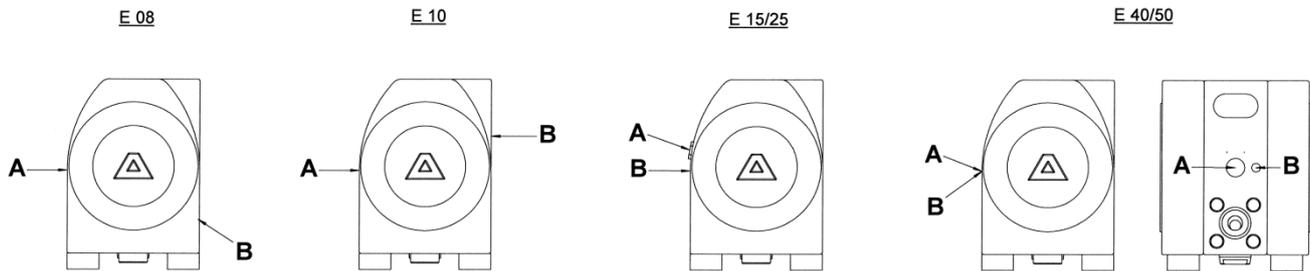
A = Luftanschluss für die Pumpe, B = Luftanschluss für die pneumatische Hubzählerfassung
