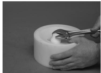
Zum Ausbau des Luftsteuersystems *PERSWING P®* beide Kopfstücke mit beigegefügttem Montagewerkzeug aus Kunststoff abschrauben. Hauptkolben und Pilotkolben entnehmen.
