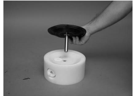
Die andere Membrane (14) mit der Kolbenstange (13) aus dem Steuerblock (16) herausziehen.
