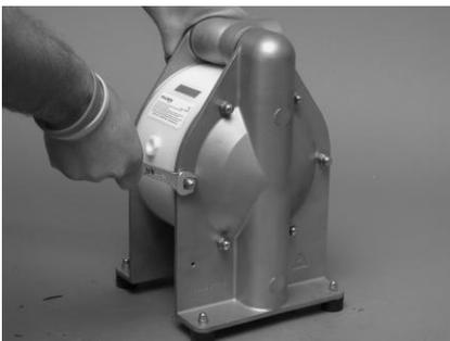
Zuganker (8) auf einer Seite der Pumpe lösen.
