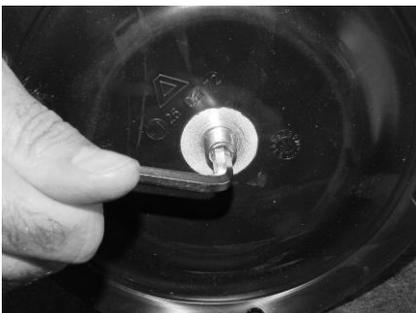
Gewindestift Kolbenstange (13a) aus den Membranen (14) schrauben.
