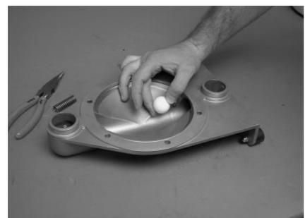
Hubbegrenzer (3) und anschließend Ventilkugeln (15) der Gehäusewange (1) entnehmen. Bei der AD 32 und der AD 50 ist für die Demontage der Hubbegrenzer die Verwendung eines Schraubendrehers vermutlich zweckmäßiger.
