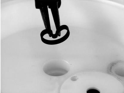
Zur Montage eines neuen Kolbenrings (17) ist dieser mit einer Sicherungsringzange vorsichtig nierenförmig nach innen zu biegen und in die Nut im Steuerblock (16) einzusetzen; danach die Aufwölbung des Ringes mit einem runden Gegenstand vollständig in die Nut drücken.
