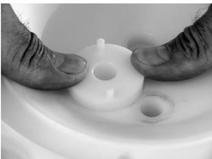
Mit der anderen Seite des Montagewerkzeugs das Steuerventilgehäuse herausdrücken.
