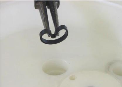
Zur Montage eines neuen Kolbenrings der Kolbenstangendichtung [20] (nur Baugrößen C 15 - C 25) ist dieser mit einer Sicherungsringzange vorsichtig nierenförmig nach innen zu biegen und in die Nut im Steuerblock [15] einzusetzen (Abb. 14.1); danach die Aufwölbung des Ringes mit einem runden Gegenstand vollständig in die Nut drücken.
