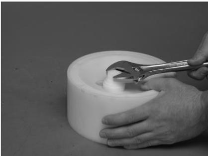
Zum Ausbau des Luftsteuersystems *PERSWING P*<sup>®</sup> (29) beide Kopfstücke mit beigefügtem Montagewerkzeug aus Kunststoff abschrauben. Hauptkolben und Pilotkolben entnehmen. Steuerventilgehäuse mit Hilfe des Montagewerkzeugs herausdrücken.
