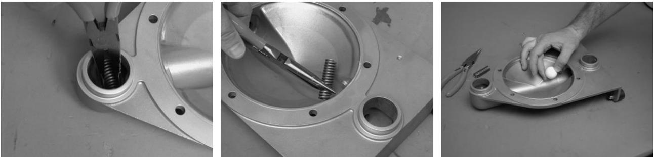
Hubbegrenzer (3) - bei AH 32 mit Schutzrohr (3a) - demontieren und anschließend Ventilkugeln (11) entnehmen. Bei der AH 32 ist für die Demontage der Hubbegrenzer die Verwendung eines Schraubendreher vielleicht zweckmäßiger.
