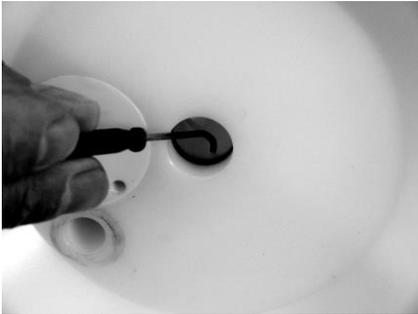
Kolbenringe (13) z.B. mit einem Schraubenzieher aus der Nut heraushebeln. Der Wiedereinbau desselben Kolbenrings (13) ist nicht möglich; er muss erneuert werden. O-Ringe (13) aus der Nut ziehen. Gleiches gilt für die Kolbenstangendichtungen (13) im Stufengehäuse (8).
