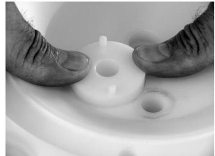
Zum Ausbau des Luftfilters (15) muss zunächst der Luftanschluss (14) abgeschraubt werden. Danach lässt sich der Luftfilter (15) ebenfalls herausschrauben.
