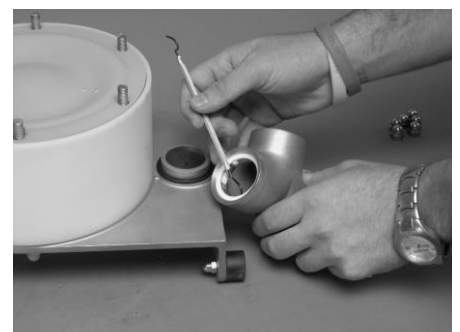
O-Ringe (10) von den Gehäusewanne abziehen; O-Ringe (9) für eventuellen Austausch den Anschlussstutzen (8) entnehmen.
