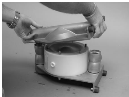
Gehäusewanne (1) und Anschlussstutzen (8) abnehmen.
