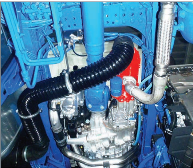
Direkte Befestigung des Verdichters an das Getriebe
