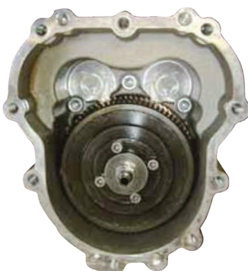
Drehmomentbegrenzer in das PTO-Modul eingebaut
